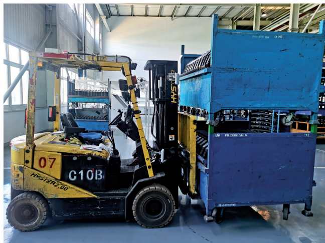
Vysokozdvížny vozík s RFID rozpozná prepravné kontajnery vybavené štítkami UHF RFID a prepraví ich na určené miesto uskladnenia.
