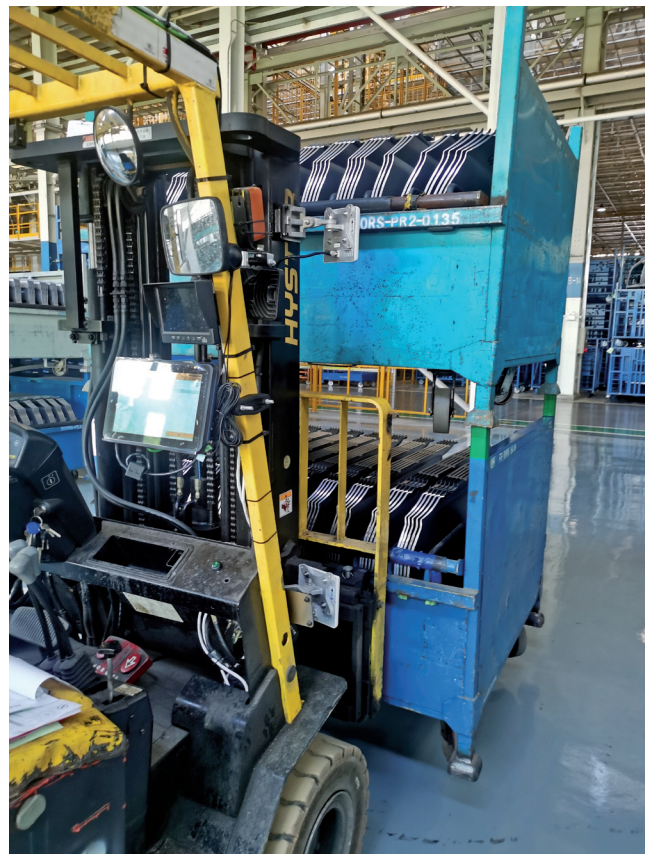
UHF anténa na vozíku identifikuje ID kontajnera a aktualizuje polohu v systéme WMS; prepravné úlohy sa zobrazujú priamo na monitore.
