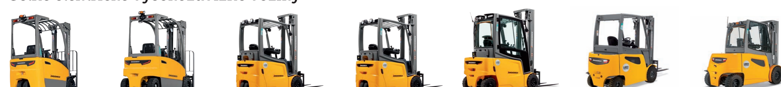
EPG BB 216k Elektrický trojkolesový vysokozdvíhací vozík Max. výška zdvíhu: 6 500 mm Max. nosnosť: 1 600 kg EPG BC 316/BC 320 Elektrický štvorkolesový vysokozdvíhací vozík Max. výška zdvíhu: 6 500 mm Max. nosnosť: 2 000 kg EPG 112 Elektrický trojkolesový vysokozdvíhací vozík Max. výška zdvíhu: 7 000 mm Max. nosnosť: 1 200 kg EPG 213-220 Elektrický trojkolesový vysokozdvíhací vozík Max. výška zdvíhu: 7 000 mm Max. nosnosť: 2 000 kg EPG 316-320 Elektrický štvorkolesový vysokozdvíhací vozík Max. výška zdvíhu: 7 000 mm Max. nosnosť: 2 000 kg EPG 425-530 Elektrický štvorkolesový vysokozdvíhací vozík Max. výška zdvíhu: 7 500 mm Max. nosnosť: 3 000 kg EPG 535k-550 Elektrický štvorkolesový vysokozdvíhací vozík Max. výška zdvíhu: 7 500 mm Max. nosnosť: 5 000 kg
