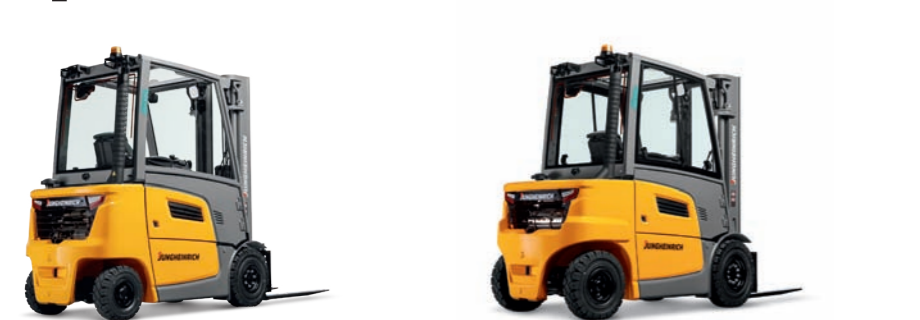
DFG/TFG 316s-320s Diesellový / plynový vysokozdvíhací vozík, hydrostatický pohon Max. výška zdvíhu: 7 500 mm Max. nosnosť: 2 000 kg DFG/TFG 425s-535s Diesellový / plynový vysokozdvíhací vozík, hydrostatický pohon Max. výška zdvíhu: 7 500 mm Max. nosnosť: 3 500 kg
