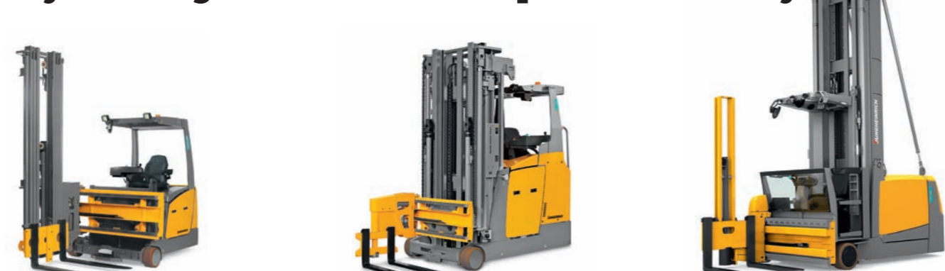
EFX 410-413** Elektrický trojstranný základáč vysokozdvíhací vozík s čelným sedením obsluhy Max. výška zdvíhu: 7 000 mm Max. nosnosť: 1 250 kg ETX 513-515** Elektrický trojstranný základáč vysokozdvíhací vozík s čelným sedením obsluhy Max. výška zdvíhu: 13 000 mm Max. nosnosť: 1 500 kg EKX 410-516k** Elektrický trojstranný základáč s vychystávacími vysokozdvíhacími vozíkmi so zdvihom obsluhy Max. výška zdvíhu: 18 000 mm Max. nosnosť: 1 600 kg
